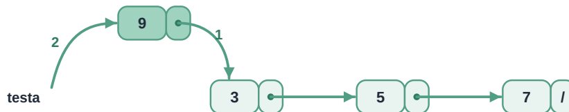
Figura 7.2. Inserimento in testa del valore 9: prima si collega il nuovo nodo (1), poi si sposta la testa (2)
