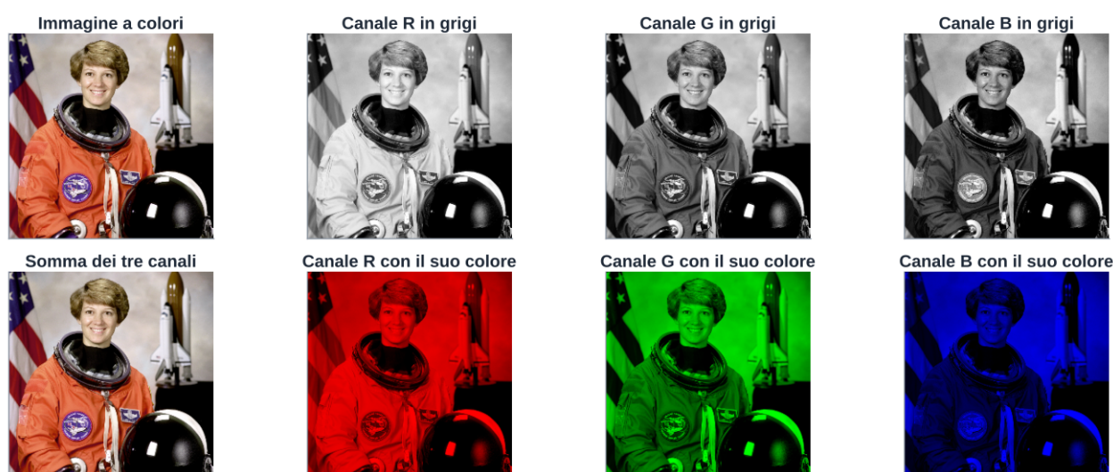
Figura 2. Un'immagine RGB scomposta nei tre canali: in alto come scale di grigi, in basso ciascun canale con il proprio colore.
