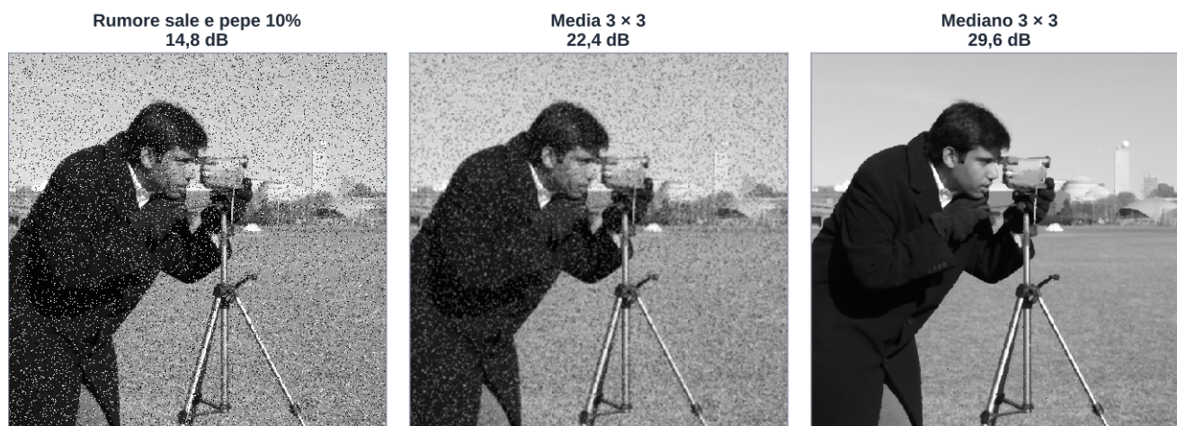
Figura 7. Rimozione del rumore sale e pepe (10%) con un filtro di media e con un filtro mediano, entrambi 3 × 3. Il mediano lo elimina quasi del tutto; la media lo spalma in macchie grigie.
