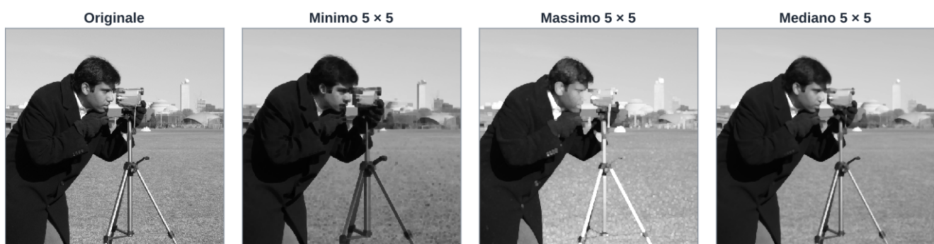
Figura 4. Filtri d'ordine con un intorno 5 \times 5 . Il minimo scurisce e allarga le zone scure, il massimo schiarisce e allarga le zone chiare, il mediano leviga i dettagli piccoli senza cambiare la luminosità media.
