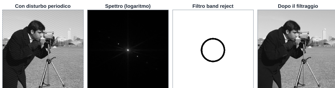
Figura 11. Un disturbo sinusoidale a strisce oblique (frequenza (60, 40)) appare nello spettro come due punti luminosi simmetrici rispetto al centro. Un filtro band reject ad anello centrato alla loro distanza (72,1, larghezza 10) lo elimina.
