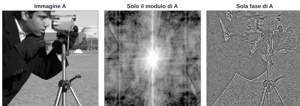
Figura 3. Ricostruzione dalla sola informazione di modulo (con fase nulla) o di fase (con modulo costante). Solo la fase conserva la struttura riconoscibile dell'immagine.
