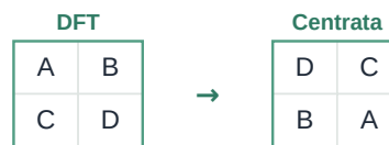
Figura 5. Lo scambio dei quadranti che porta la frequenza zero al centro dello spettro.
