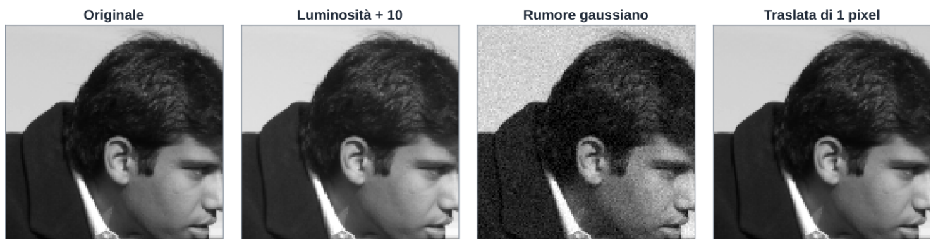
Figura 4. Quattro immagini a confronto (ritaglio). MSE e PSNR rispetto all'originale: luminosità più 10 con MSE 99,6 e PSNR 28,1 dB; rumore con MSE 97,8 e PSNR 28,2 dB; traslazione di 1 pixel con MSE 251,6 e PSNR 24,1 dB.
