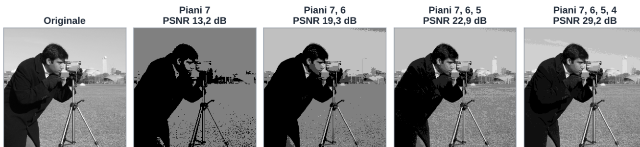
Figura 2. Ricostruzione con i soli piani più significativi (gli altri piani messi a zero). Con i piani 7 e 6 l'immagine assume solo i valori 0, 64, 128 e 192.
