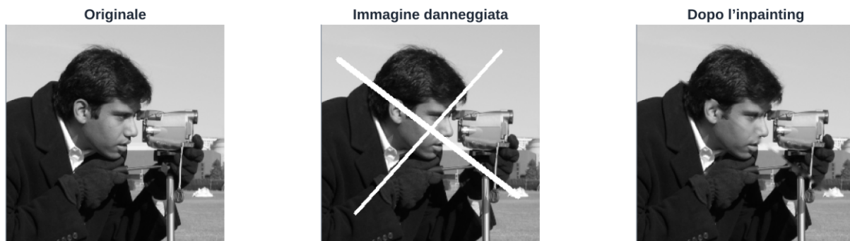
Figura 2. Due graffi bianchi su una fotografia (al centro) rimossi con un algoritmo di inpainting (a destra).
