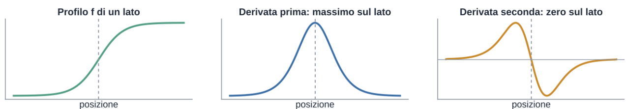
Figura 2. Un profilo di luminanza con un lato, la sua derivata prima (che ha un massimo in corrispondenza del lato) e la sua derivata seconda (che passa per lo zero in corrispondenza del lato, con un valore positivo da una parte e negativo dall'altra).
