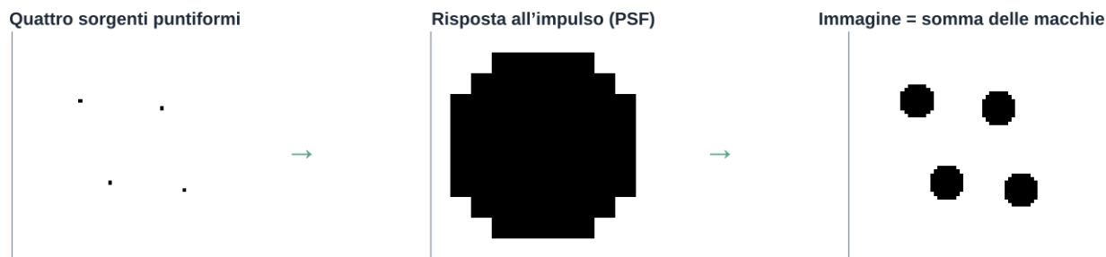
Figura 3. Quattro sorgenti puntiformi (a sinistra) attraversano un sistema la cui PSF è un piccolo disco (al centro): l'immagine finale è la somma delle quattro macchie (a destra). Calcolata con una convoluzione.
