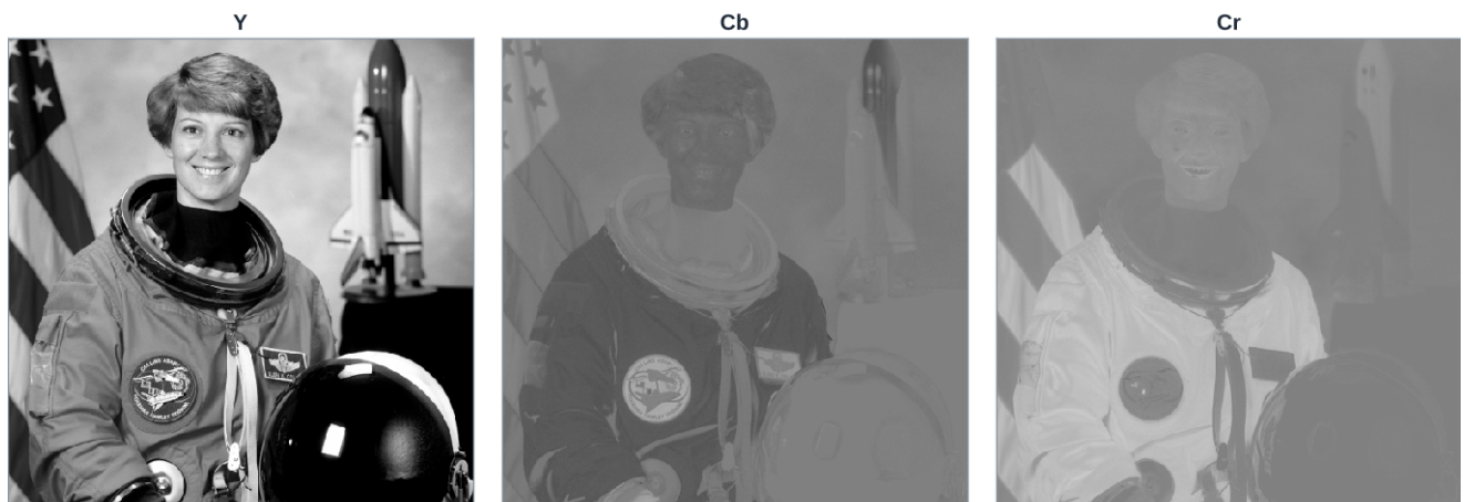
Figura 2. Le tre componenti dello spazio YCbCr. Quasi tutto il dettaglio è in Y; Cb e Cr sono molto più lisce, e per questo si possono ridurre di risoluzione senza accorgersene.
