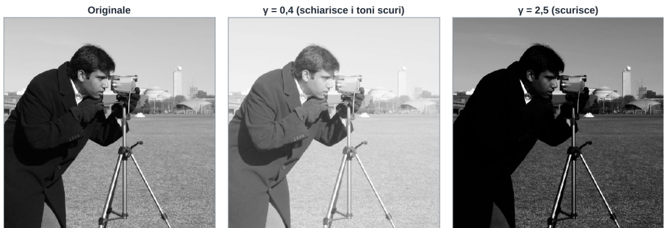
Figura 4. Trasformazione di potenza con \gamma minore e maggiore di 1.
