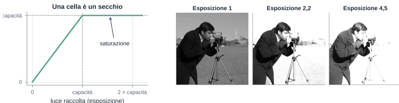
Figura 3. A sinistra la risposta di una cella, lineare fino alla capacità e poi costante. A destra la stessa scena con esposizione crescente: nelle zone chiare la cella satura e il dettaglio scompare.
