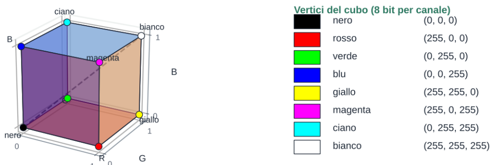
Figura 1. Il cubo RGB. Ogni colore è un punto del cubo; la retta che congiunge il nero e il bianco, in cui R = G = B , è la retta dei grigi.
