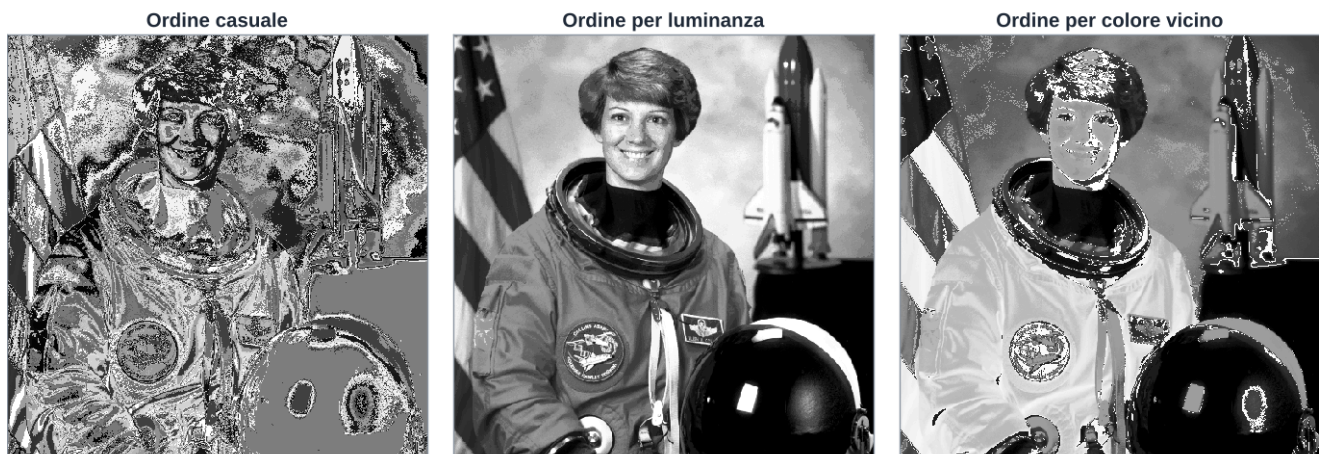
Figura 4. La stessa immagine a 64 colori, con la matrice degli indici visualizzata in grigi per tre diversi ordinamenti della palette. Con indici vicini a colori simili l'immagine è regolare.
