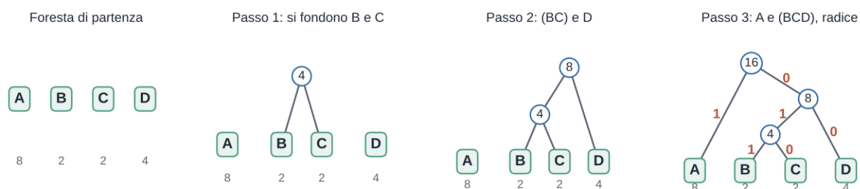
Figura 1. Costruzione dell'albero. B e C (peso 2 ciascuno) sono i più leggeri e si fondono in un nodo di peso 4; poi (BC) e D, entrambi di peso 4, si fondono in un nodo di peso 8; infine A (8) e (BCD) (8) formano la radice, di peso 16. I rami sinistri sono etichettati con 1, i destri con 0.
