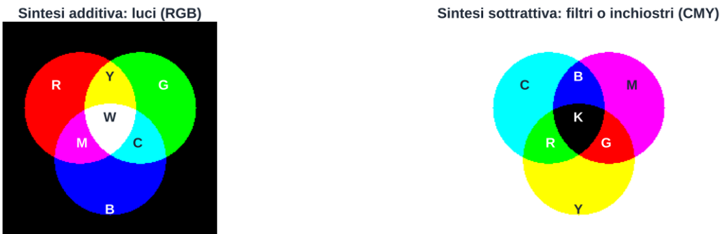
Figura 2. A sinistra la sintesi additiva, a destra la sottrattiva: i colori secondari dell'una sono i primari dell'altra, e viceversa.
