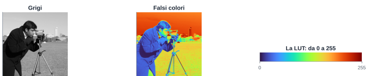
Figura 8. Presentazione in falsi colori: a ogni livello di grigio si associa, attraverso una LUT con tre colonne (R, G, B), un colore. I pixel non cambiano, cambia solo come li si vede.
