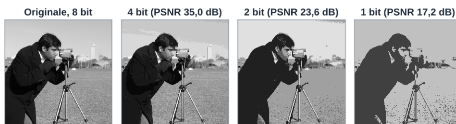
Figura 4. La fotografia a 8 bit e dopo avere conservato soltanto i 4, 2 e 1 bit più significativi. Con 4 bit il difetto è lieve; con 2 e 1 bit compaiono bande di grigio uniforme e i dettagli sfumati scompaiono.
