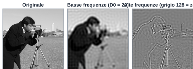
Figura 3. L'immagine come somma di una parte a basse frequenze, che contiene le zone uniformi e le grandi forme, e di una parte ad alte frequenze, che contiene bordi, dettagli e rumore.
