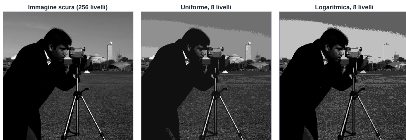
Figura 3. Su una fotografia scura la quantizzazione uniforme a 8 livelli schiaccia il volto e il cappotto in due o tre tonalità quasi nere, quella logaritmica ne conserva meglio la struttura, a prezzo di una resa molto grossolana dei toni chiari come il cielo. Per la visualizzazione ogni livello è riportato al centro del suo intervallo di ingresso.
