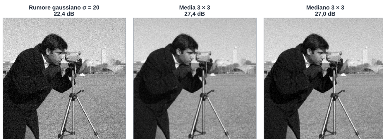
Figura 8. Rimozione del rumore gaussiano con gli stessi filtri. Qui la media ottiene un risultato leggermente migliore.
