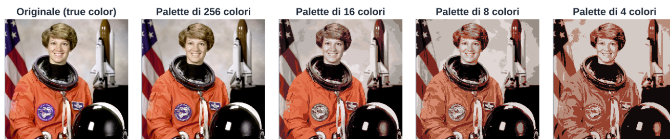
Figura 2. Una immagine indicizzata con palette ottimizzata (algoritmo del taglio mediano) con 256, 16, 8 e 4 colori.
