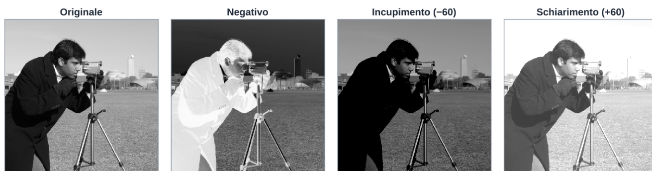
Figura 2. Negativo, incupimento e schiarimento di una fotografia: i valori fuori scala vengono portati a 0 o a 255.
